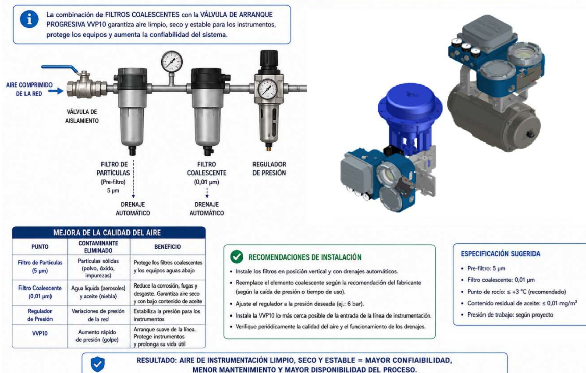
Figura 2.22 – Uso de filtro coalescente para mejorar la calidad del aire de instrumentación.
